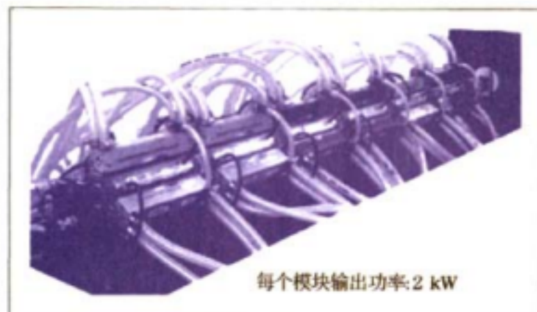
图3 12 kW 激光器实验装置图
