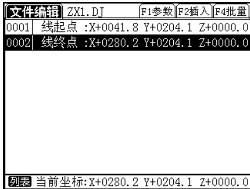
图2-8 直线终点定位已完成
