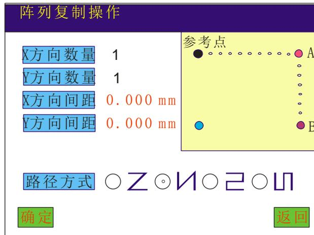
方法一：输入要阵列复制 X 方向数量和 Y 方向数量，然后按“MOVE”键移动到 X 方向最后一点（也就是图中的 A 点），按“确认”；再移动到 Y 方向最后一点（也就是图中的 B 点）按确认；即可自动计算间距。一定要先输入复制数量。 路径方式：运行轨迹选择。
