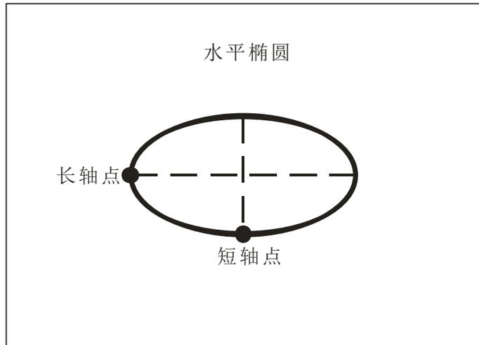
首先编辑椭圆上长轴点坐标，再编辑椭圆上短轴点坐标，编辑方法和编辑点坐标相同。如图所示：
