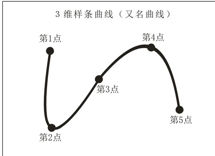
样条曲线是指给定一组控制点而得到一条曲线，曲线的大致形状由这些点予以控制。采集轮廓上一系列点即可描述这条曲线。因此曲线的编辑也是一系列点坐标的编辑，编辑方法同“点”坐标编辑相同，每指定一个点按“确认”键，即可加入此点，当编辑完所有点时按“返回”键来结束点的采集。
