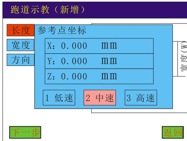
2、按“下一步”再通过方向键移动到长度的另一端点（测量点），再按下确认键，即可自动计算出两点间的距离。
