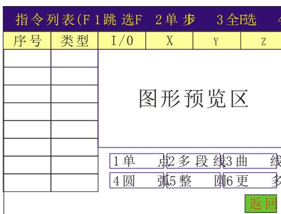
在指令列表对话框下，按数字键1~5可编辑图中对应的图形元素，更多图形选择按数字键6进入。
