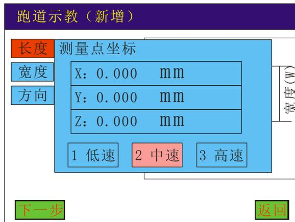
3、要测量宽度的数据时，将光标移动到“宽度”上，方法同测量长度一样。
