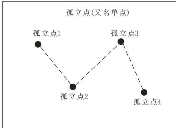
按数字键 1 直接进行点坐标教导，点的坐标可以通过方向键来移动 “左 X 键” → X 轴左移、“右 X 键” → X 轴右移，“上 Y 键” → Y 轴上移、“下 Y 键” → Y 轴下移，“上 Z 键” → Z 轴上移、“下 Z 键” → Z 轴下移。按“确认”键新增指令成功。退出教导，直接按“返回”键，如图所示：
