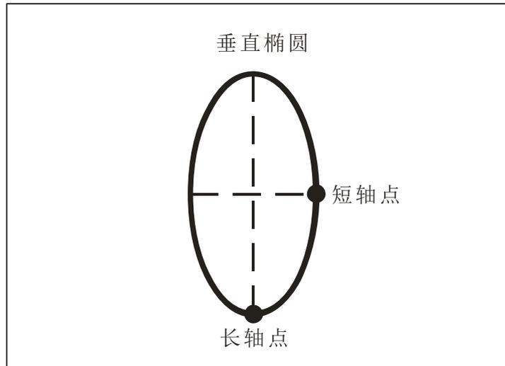
首先编辑椭圆上长轴点坐标，再编辑椭圆上短轴点坐标，编辑方法和编辑“水平椭圆”相同。
