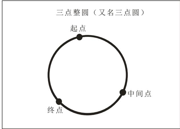
首先编辑圆弧的起点坐标，再编辑圆弧的中间点坐标，最后编辑圆弧的终点坐标，编辑方法和编辑“XY 圆弧”相同。编辑“起点”-“中间点”-“终点”即可。
