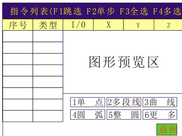
在此画面下可新增需要的图形指令，按数字键 1~5 可编辑图中对应的图形元素，更多图形选择按数字键 6 进入。操作同 4.1 介绍。
