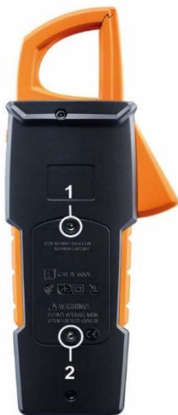
2. 用一把螺丝刀松开电池盒的两个金属螺钉（1，2），直到可以卸下电池盒盖。不用将螺钉完全拧出。
