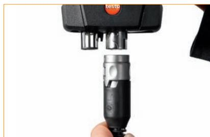
因此 testo 320 高效烟气分析仪可实现供暖系统的多种测量，不仅因为其丰富的测量菜单，还得益于它的探头理念。如果没有 testo 320 这些可用的探头，您可能就需要购置额外的仪器以完成相应的功能了。仪器革新化的探头接口，更换探头简单方便：单个卡口连接适于所有探头，也就是说通过这一个接口，一条气路，可将所有气路都连接至仪器。
