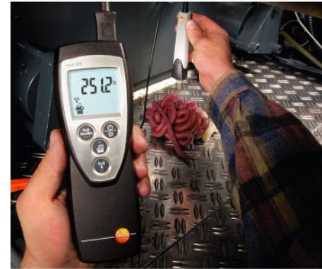
连接快速刺入式探头，测量半固体物质的温度，特别适用于塑料、食品等测量
