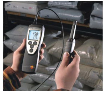
连接湿度探头, 测量仓库内的环境条件
