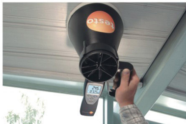
testo 417，检测通风口的空气流量
