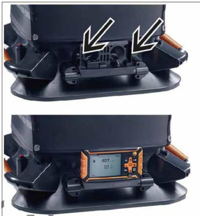
1. 将 testo 420 完全推入仪器底座，注意支撑架右侧和左侧的夹具。
