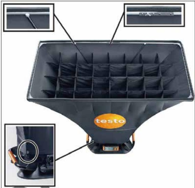
1. 安装铝框，拉伸风量罩，使之覆盖框架，以使弹性带位于框架凹槽之中。确保弹性带正确地贴合，特别是在拐角处。
