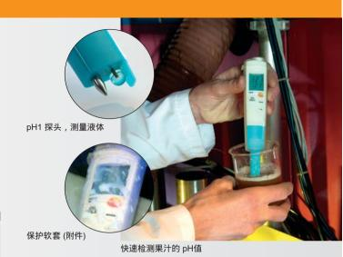
技术数据 传感器 pH电极 NTC 量程 0 ~ 14pH 0~+60 (短期达80 ,5分钟) 精度 ±0.02pH ±0.4 分辨力 Hq10.0 0.1 存放温度 -20 ~ +70 工作温度 0~+60 补偿功能 自动温度补偿 测量速率 2次/s 电池寿命 80h(10分钟自动关机) 尺寸 197×33×20mm
