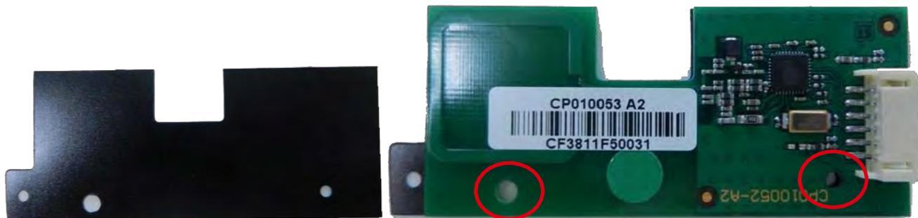
5.将新板插到托架末端，检查新板的定位销是否对位。
