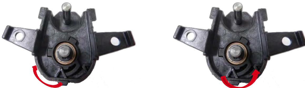
4. 安装齿轮 (a) 并将其卡到电机齿轮上 (b)。
