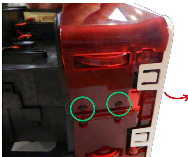
2.2 拆下固定块 (a) 并取下送卡器 PCB (b)。
