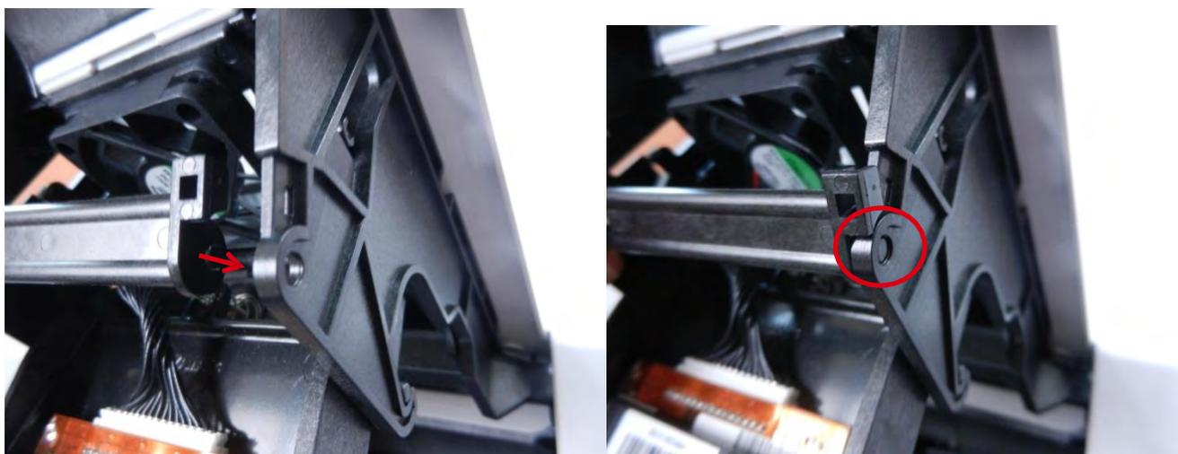
8. 轻微移动打印头托架，在第二个孔中插入支架第二个插销。
