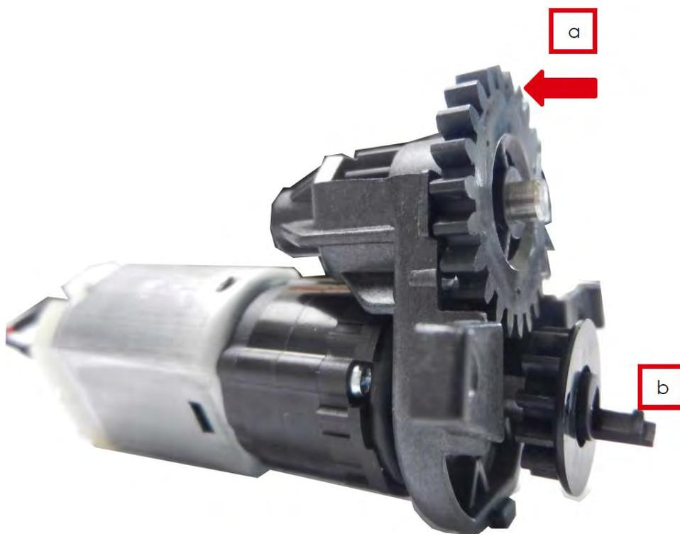
5. 将电机插入托架并拧上两个螺钉。
