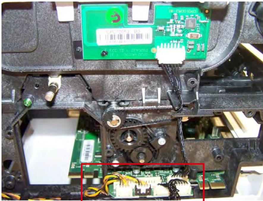
3.转动托架，取下三颗螺钉，取下旧主板。
