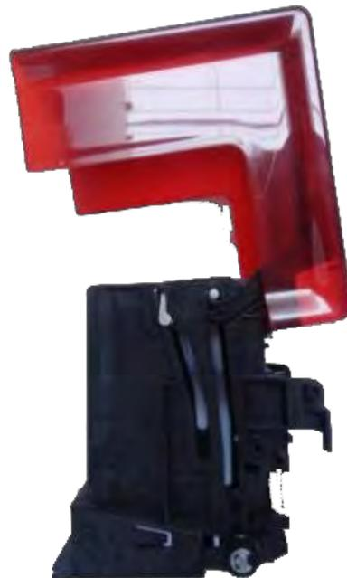
9.将新的送卡器顶部插到两个导槽内。
