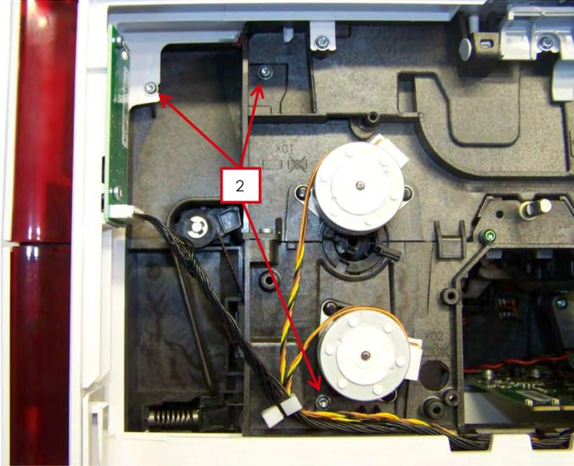
3. 取下另一侧的三颗螺钉和送卡器接线。
