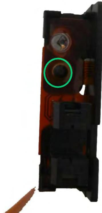
d. 将组装好的套件穿过支架（1）并将根据窗口（2）放置传感器。按住以锁定（3）。检查其是否卡好。
