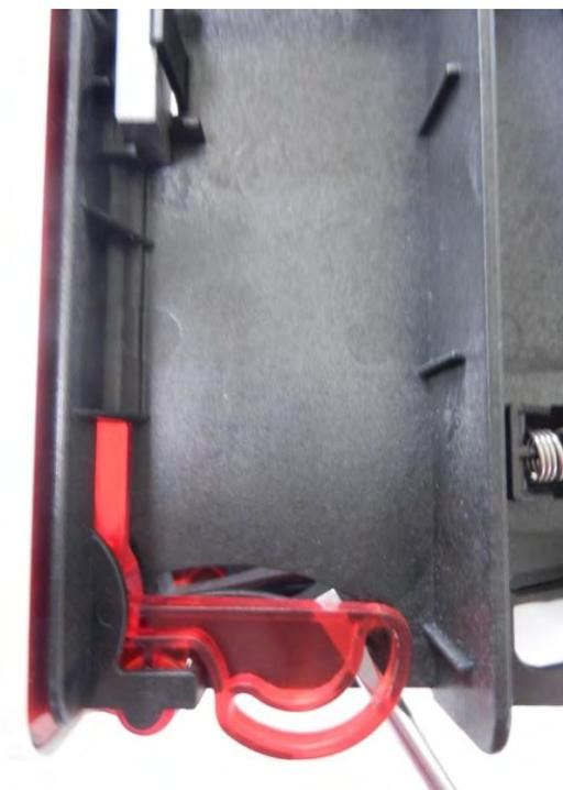
6. 推动分开托架两侧的送卡器门。
