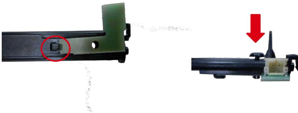
7. 在打印头托架孔中插入支撑销。
