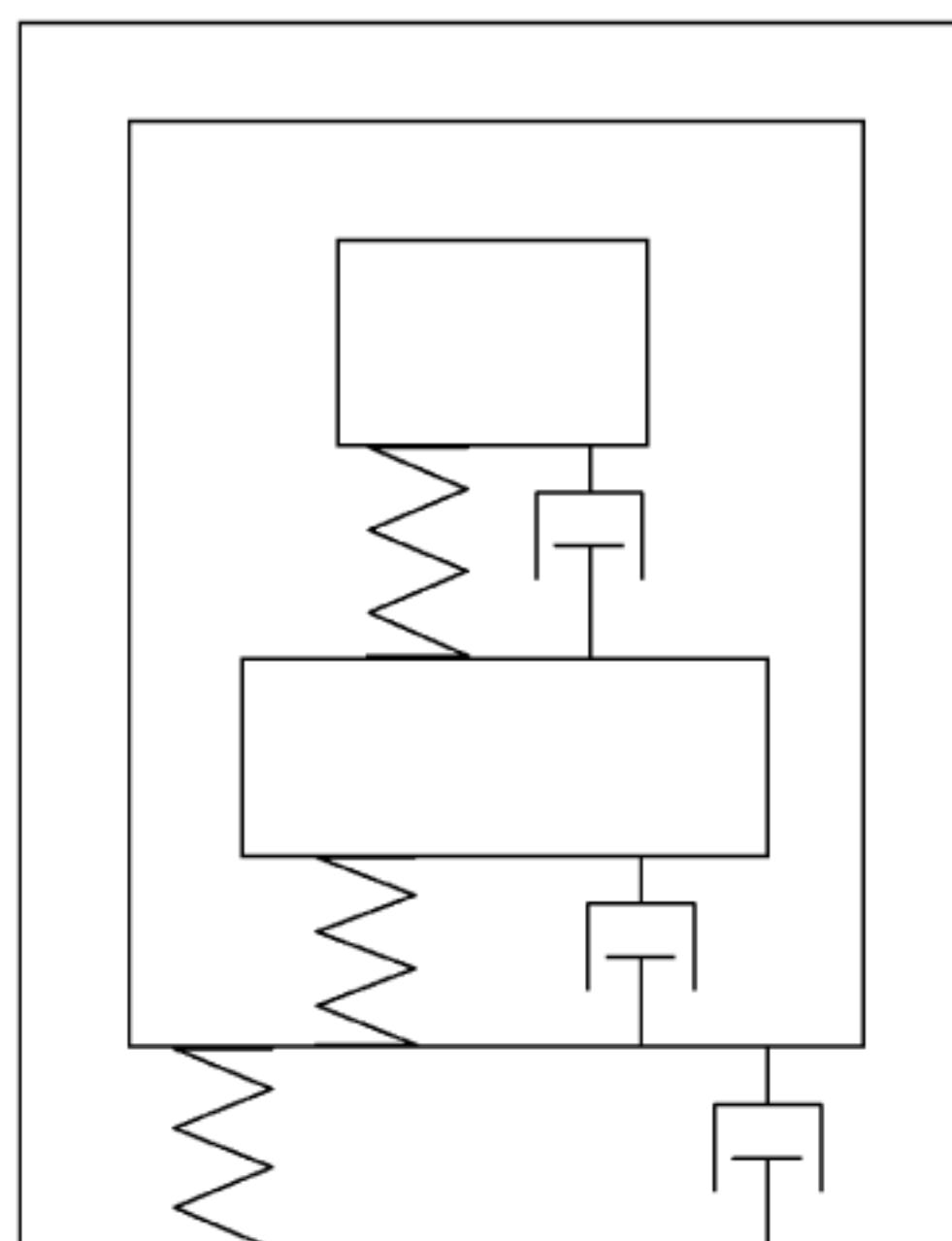
图 B.3 有多自由度系统的框架
