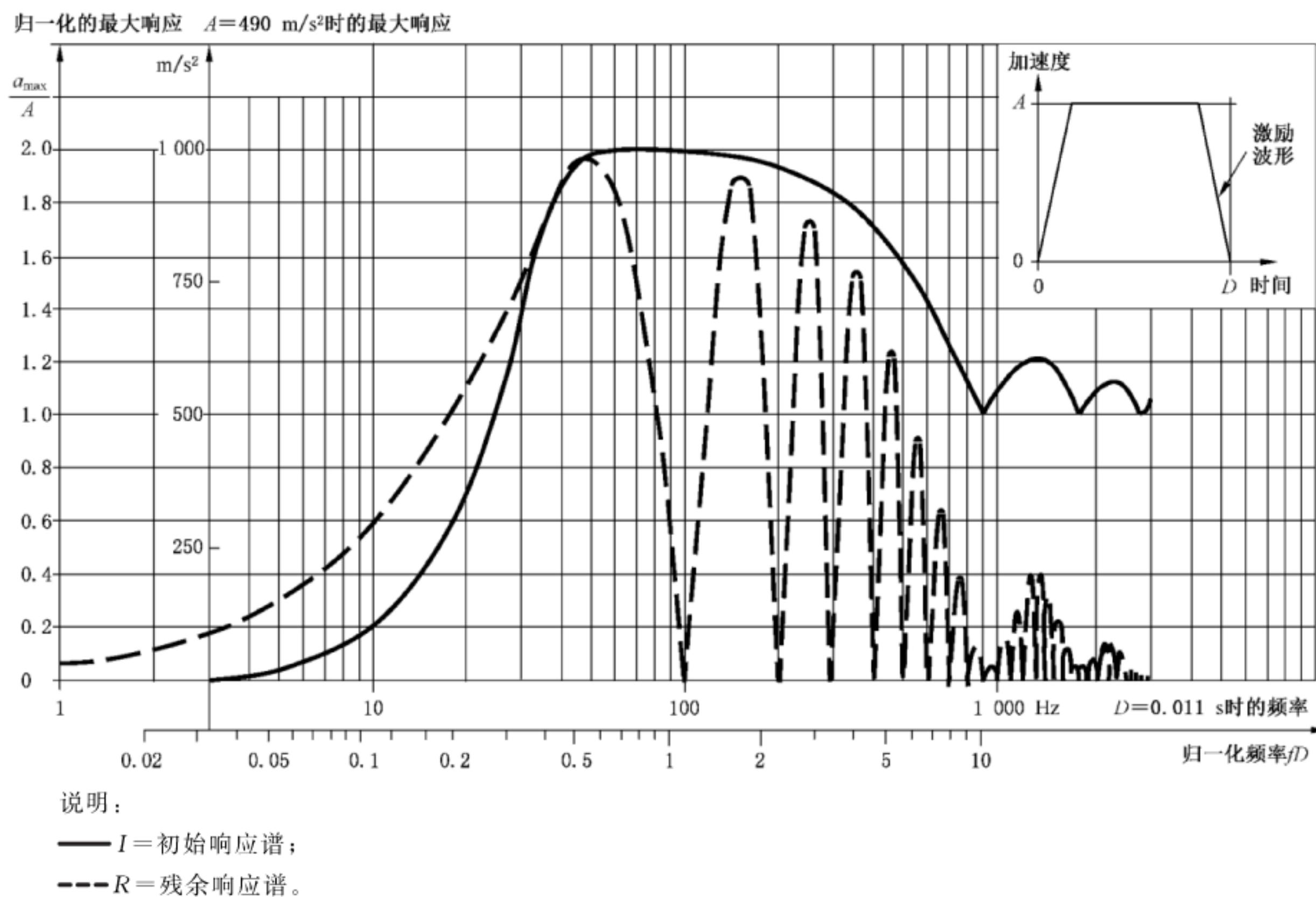
图 A.3 对称梯形脉冲的冲击响应谱
