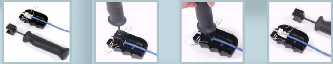
① 对线对卡进插 ② 将一次冲压 ③ 气泵式工具手柄自动切线 ④ 4对线同时切断
