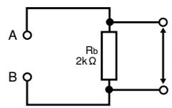
●测量回路网(网络B1 IEC60990 图4 符合U1测量标准)
