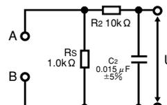
●测量回路网(网络C IEC60990 图5 符合U3测量标准)
