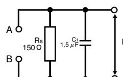
●测量回路网(网络E 电器和材料安全法等)
